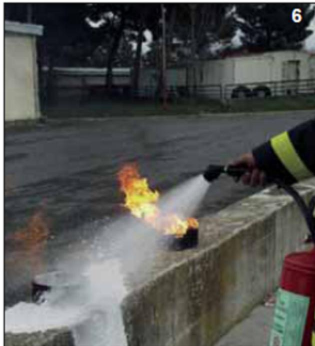
Come è stato accennato in precedenza, l'estintore portatile è un mezzo per l'estinzione del principio d'incendio. In genere l'incendio ha uno sviluppo alquanto repentino soprattutto in determinate condizioni: tipo di combustibile, presenza di correnti d'aria favorevoli, geometria del locale ecc., in questa prima fase l'azione di un estintore portatile ben utilizzato può evitare il rischio di giungere al flash over e quindi all'incendio generalizzato.
