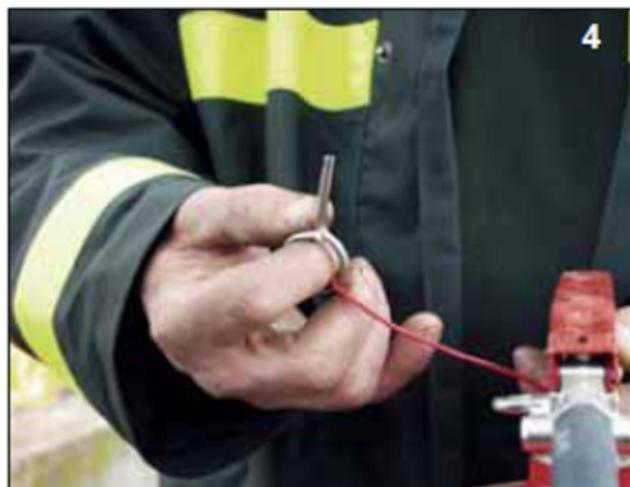
In questa fase, si controllano i vari dispositivi di erogazione, tubo, lancia, attacco valvola-tubo e si procede a sfilare il sigillo di sicurezza.
